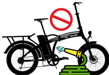
Prima di avviare la bicicletta a pedalata assistita, asciugare completamente con aria compressa a bassa pressione e verificare che non sia rimasta umidità residua sui componenti elettrici.
